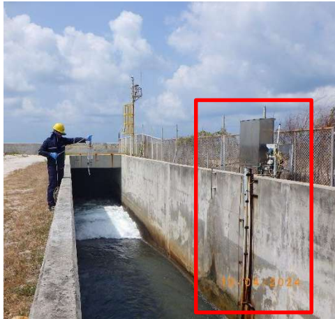
รูปที่ 2-11 ระบบตรวจวัดอุณหภูมิของน้ำทะเลอย่างต่อเนื่อง
